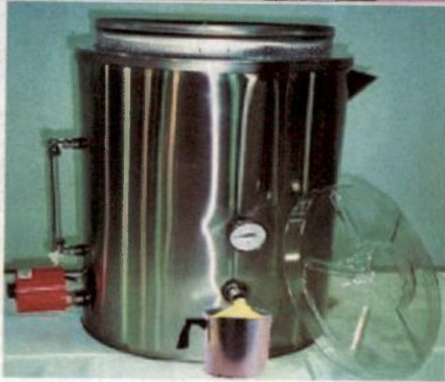
▲ شکل ۲-۶-۲- روش استخراج و تصفیه موم با بخار آب
