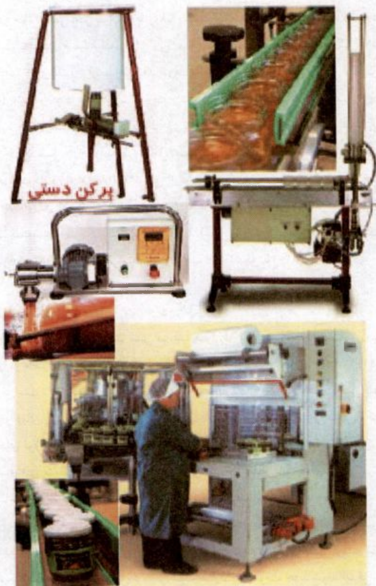
▲ شکل ۱-۲۳-۱- مرحله پرکردن و بسته‌بندی عسل با پرکن دستی و اتوماتیک
