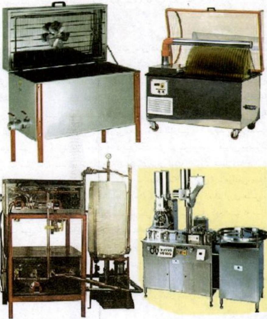
▲ شکل ۲۱-۱- رطوبت‌گیری عسل با دستگاه‌های هواده و خشک‌کن در خلأ
