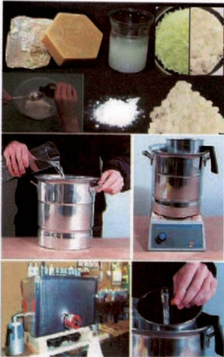
▲ شکل ۲-۸-۲- رنگبری موم با استفاده از مواد شیمیایی
