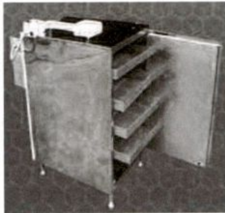
شکل ۷-۶: دستگاه گرده خشک‌کن با حرارت غیرمستقیم ساخت ایران
