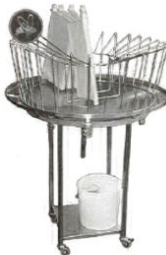
شکل ۴-۴: تراشی سینی مخصوص قرار دادن قاب‌ها پس از پولک‌تراشی
