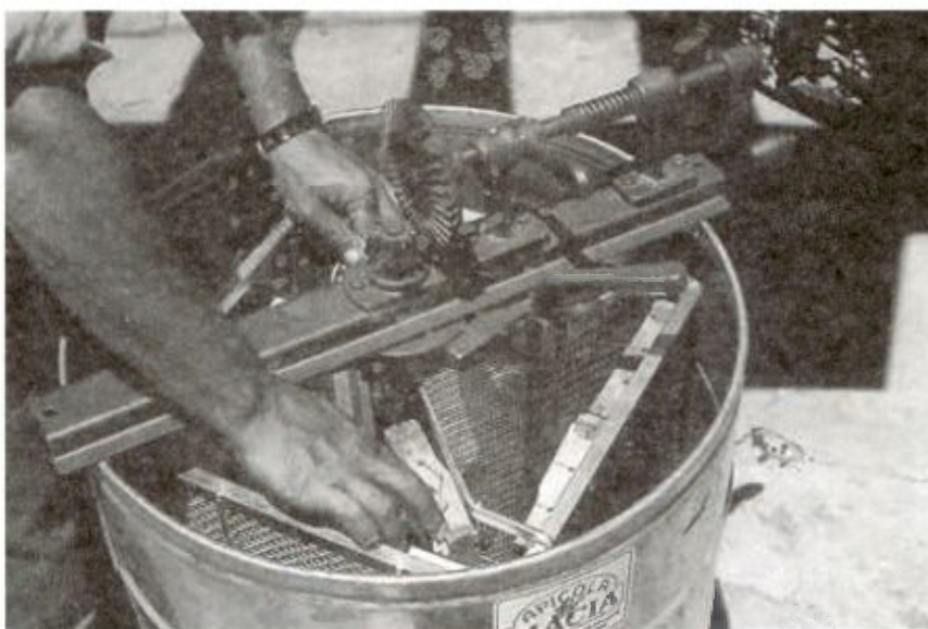
شکل ۴-۹: نحوه قرار گرفتن قاب در یک نوع از اکستراکتور جداری
