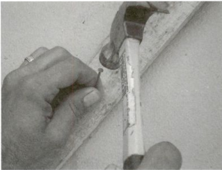
شکل ۲-۴: نحوه صحیح کوبیدن میخ به داخل چوب
